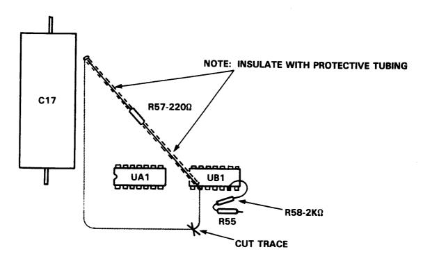
3) INSTALL JUMPER WIRES:
